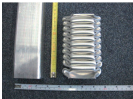
Crash- und Stauchverhalten in der Detailaufnahme
