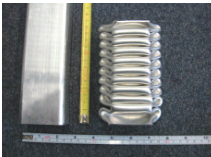
Crash- und Stauchverhalten in der Detailaufnahme
