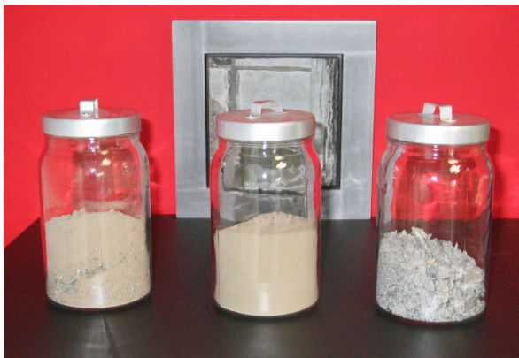
v.l.n.r.: Zinkbadabschöpfung (Zinkasche), Filterstaub, Hartzink
